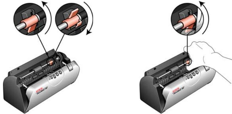
3. Cuando está desbloqueado, el rodillo se puede quitar de sus zócalos de montaje. Presione cuidadosamente el rodillo hacia la derecha para liberar su lado izquierdo. Luego, incline el rodillo hacia la parte frontal del escáner hasta que salga del alojamiento y extráigalo del cuerpo del escáner.
