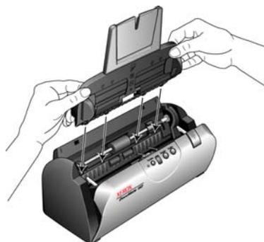
4. Gire hacia atrás la guía de la guía del papel hasta que encaje en su posición. Cierre la cubierta del escáner. Voltee hacia arriba la extensión de la guía del papel de modo que quede completamente extendida.
