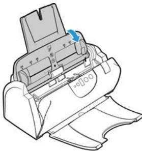
3. Le rouleau est maintenu en place à l'aide d'un ergot de verrouillage pivotant. Pour déverrouiller l'ergot, faites-le pivoter vers le haut jusqu'à libérer complètement l'aillette de verrouillage.
