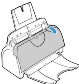
3. Frottez les rouleaux d'un côté à l'autre. Faites tourner les rouleaux vers le bas pour en nettoyer toute la surface. Nettoyez la vitre et la plaque de fond dans le corps du scanner.
