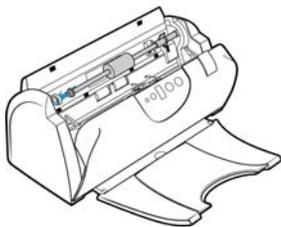
9. Lorsque vous êtes certain que les engrenages sont correctement engagés, faites pivoter l'ergot de verrouillage vers le bas de façon à ce que l'ailette de verrouillage se loge en place.
