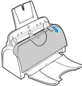
2. Extrayez le bac d'entrée du papier. Le rouleau se trouve dans le corps du scanner, derrière le bac d'entrée.
