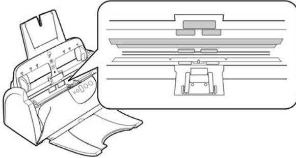
4. Essuyez le tampon de l'AAD de haut en bas. Veillez à ne pas accrocher le chiffon aux ressorts situés de part et d'autre du tampon. Frottez les rouleaux libres d'un côté à l'autre. Faites tourner les rouleaux vers le bas pour nettoyer toute la surface de chaque rouleau.
