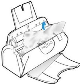
Pour réduire les bourrages papier, lissez le papier avant de numériser, ajustez les guides à la taille du papier, puis insérez correctement le papier dans l'AAD.
