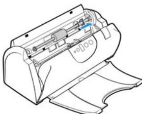
5. Imprimez ensuite un angle au rouleau vers l'avant du scanneur jusqu'à ce qu'il sorte de son logement, puis extrayez-le du scanneur.
