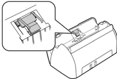
3. Serrez les pinces en plastique qui maintiennent en place le bloc du tampon, puis soulevez-le pour l'extraire. Pour mettre en place le tampon neuf dans son logement, procédez de façon inverse.
