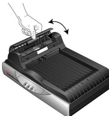
3. Faites glisser l'ergot de verrouillage sur la face inférieure du scanner en position déverrouillée. Le scanner ne numérise pas lorsqu'il est verrouillé.
