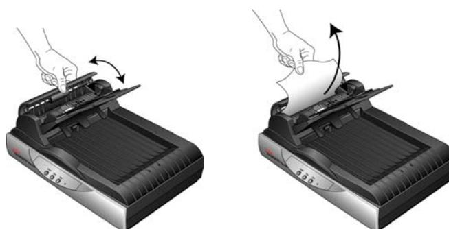
Pour réduire les brouillages papier, lissez le papier avant de numériser, ajustez les guides à la taille du papier, puis insérez correctement le papier dans l'AAD.
