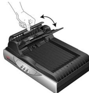
3. Essuyez le rouleau de chargement d'un côté à l'autre. Faites pivoter le rouleau pour le nettoyer entièrement.
