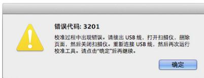
注意：如果您不使用扫描仪附带的校准页，而是尝试使用任何其他纸页来校准扫描仪，则校准程序会失败。此时，您需要拔下然后插回 USB 电缆，以重启扫描仪，然后重新开始校准。
