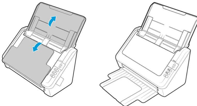
4. Abra la cubierta del alimentador automático de documentos y quite la cinta o la espuma protectora del interior del alimentador. Cierre la cubierta del alimentador cuando haya terminado.
