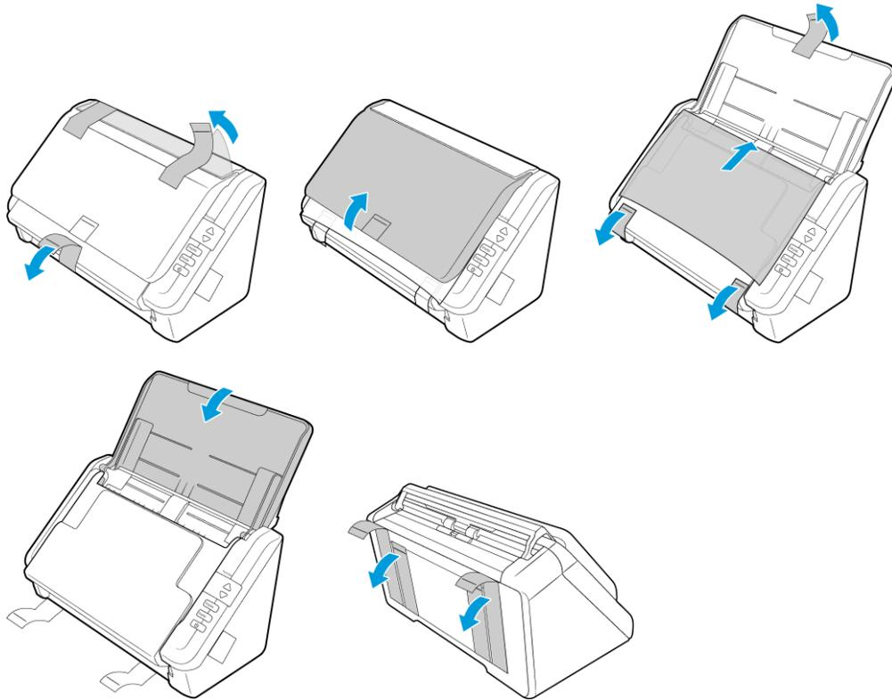
3. Levante la bandeja de entrada hacia arriba del escáner. Tire la bandeja de salida hacia abajo del cuerpo del escáner. Encajará en posición cuando haya tirado lo suficiente.
