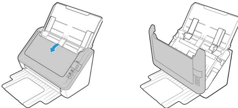
2. Presione las abrazaderas plásticas que mantienen el ensamblaje de la almohadilla en su posición y levante la almohadilla para extraerla. Invierta el procedimiento para instalar la nueva almohadilla en sus ranuras.
