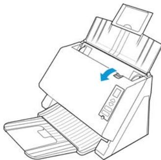
3. Limpe os rolamentos de alimentação e separação de uma extremidade a outra. Gire os rolamentos para baixo e limpe toda a superfície de cada rolamento. Passe o pano na chapa de vidro e de fundo no corpo do scanner.
