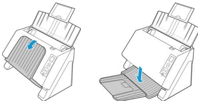
5. Abra a tampa do ADF e remova cuidadosamente quaisquer pedaços de espuma que possam ter entrado no alimentador automático de documentos.
