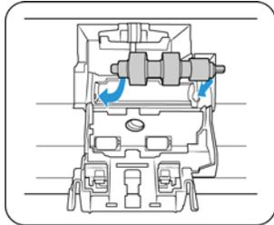
9. Levante a tampa do rolo e empurre-o cuidadosamente até que trave no lugar. Verifique se tudo está alinhado adequadamente e se a tampa está totalmente fechada. Se a tampa não estiver totalmente fechada, será quebrada durante a digitalização e danificará o scanner.
