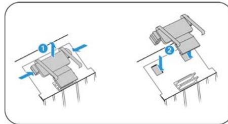
**Substituição do rolamento de separação**
