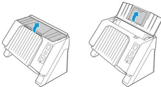
4. Puxe a bandeja de saída para baixo do corpo do scanner. Ela travará no lugar quando estiver totalmente abaixada. Certifique-se de que a parte inferior da bandeja esteja completamente abaixada antes de realizar digitalizações. Se a bandeja não estiver completamente encaixada na posição, a alimentação de papel através da bandeja de entrada poderá atolar no scanner.
