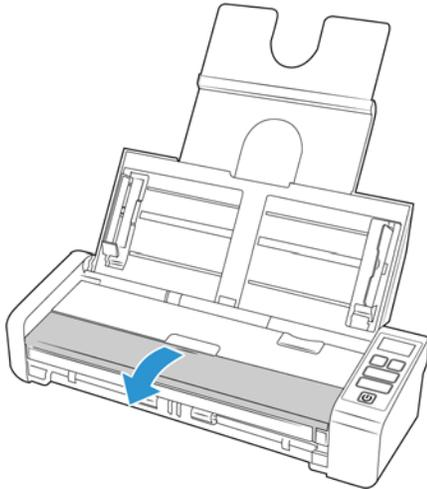
2. Coloque um item voltado para cima, na bandeja de alimentação frontal ou traseira, alinhado com as marcas de registro na bandeja e insira-o no scanner.
