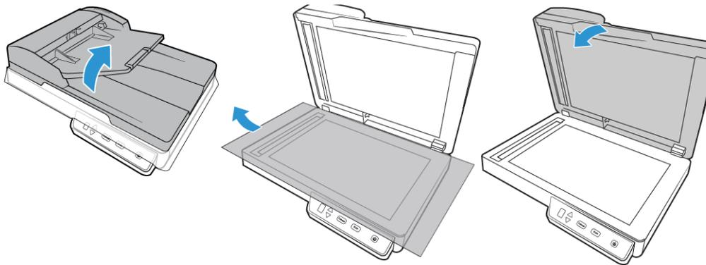
4. Abra la cubierta del alimentador automático de documentos y quite la cinta o la espuma protectora del interior del alimentador. Cierre la cubierta del alimentador cuando haya terminado.
