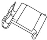
1. Tirez sur le couvercle de l'AAD pour ouvrir le scanneur.
