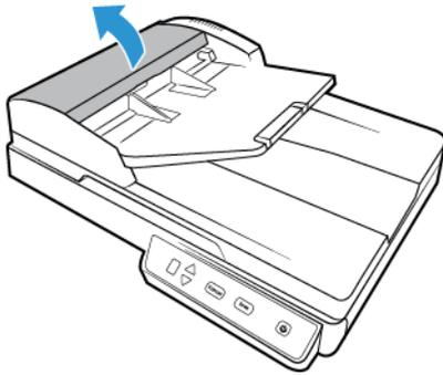
3. Essuyez le rouleau d'alimentation d'un côté à l'autre. Faites pivoter le rouleau pour le nettoyer sur toute sa surface. Le rouleau d'alimentation se situe dans le bas de la porte de l'AAD.
