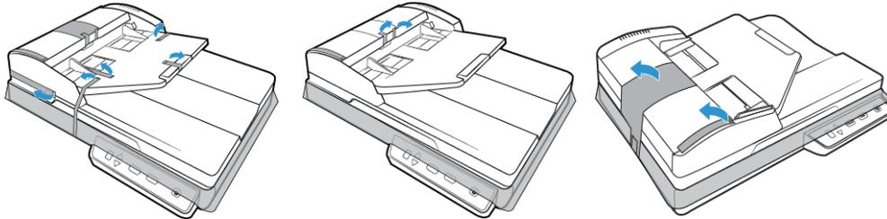
3. Levante la tapa del escáner. Quite la cinta y la espuma protectora que haya alrededor o sobre el vidrio de la base plana.
