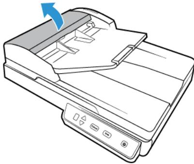
3. Limpie el rodillo de alimentación de lado a lado. Gire el rodillo para limpiar toda su superficie. El rodillo de alimentación está ubicado en la parte inferior de la puerta del ADF.
