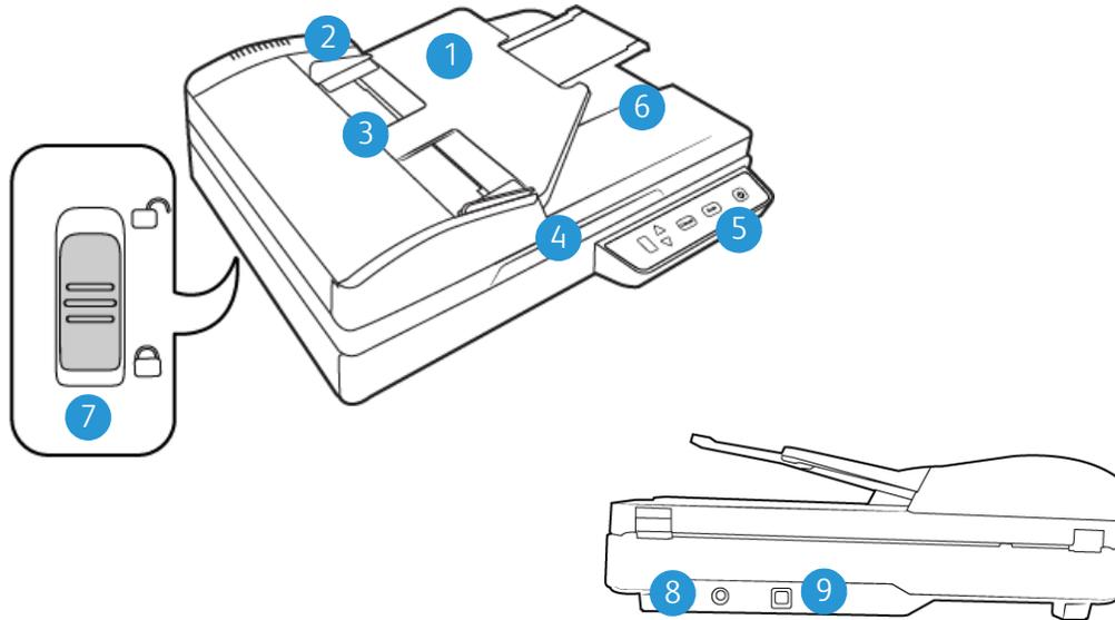
1. **Bandeja de entrada:** mantiene el papel en el escáner. Se despliega para admitir papel de distintas longitudes.
