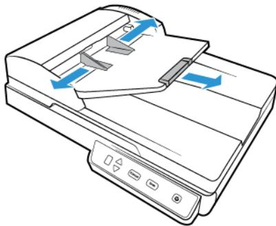
2. Coloque la pila de documentos *hacia arriba* en el alimentador automático de documentos, insertando primero su borde superior.
