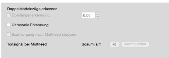
**Doppelblatteinzüge erkennen** bezeichnet die Fähigkeit des Scanners zu erkennen, ob zwei oder mehr Seiten gleichzeitig eingezogen wurden oder eine unerwartet lange Seite gescannt wird.
