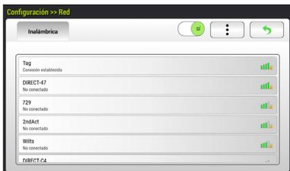
5. Seleccione una red inalámbrica. Si se le solicita, introduzca la contraseña de red. En unos segundos, si la conexión es exitosa, la dirección IP del escáner se mostrará en la parte superior de la pantalla LCD.
