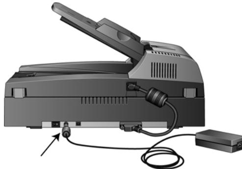
**NOTA:** Utilice solamente el suministro de alimentación incluido con su escáner (HEG42-240200-7L fabricado por HiTron). La conexión de cualquier otro tipo de suministro de alimentación puede dañar el escáner e invalidará su garantía.
