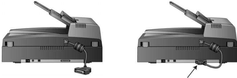
7. Empuje hacia abajo la lengüeta de bloqueo a la posición de desbloqueo.
