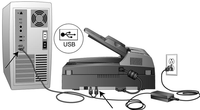
El símbolo USB, que aparece en el diagrama anterior, identifica la ubicación del puerto USB en la computadora. Si el conector no entra con facilidad, asegúrese de estar conectándolo correctamente. No fuerce el conector para realizar la conexión.
