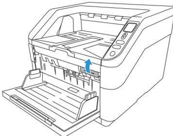
Une fois les rouleaux remplacés, fermez soigneusement le scanner en appuyant sur les deux côtés du couvercle jusqu'à ce qu'un déclic se produise. Ne claquez pas le couvercle.
