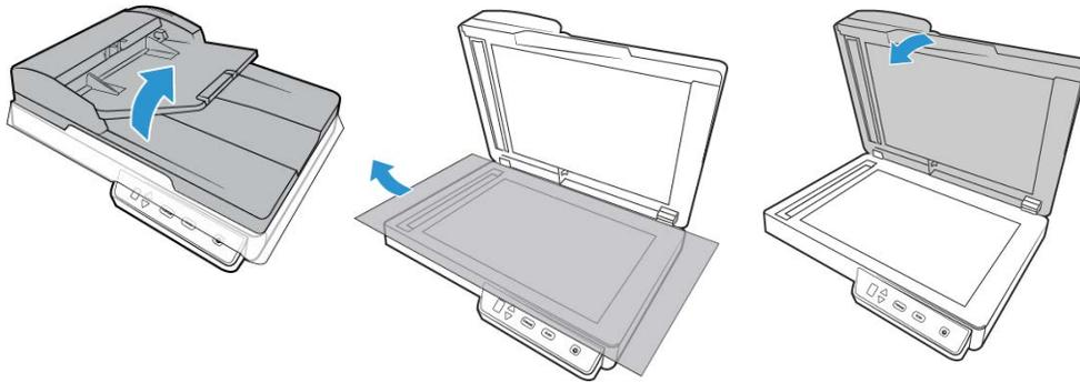
4. 자동 문서 공급 장치 덮개를 열고 장치 내부의 테이프나 보호용 폼을 모두 제거합니다. 완료되면 공급 장치 덮개를 닫습니다.
