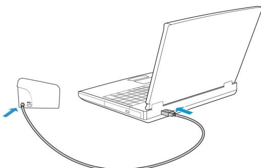
**참고 :** 스캐너와 함께 제공되는 USB 전원 케이블만 사용하십시오. 다른 종류의 USB 전원 케이블을 연결하면 스캐너가 손상될 수 있으며, 보증이 무효화됩니다. USB 전원 케이블이 없는 경우 고객 서비스 부서에 연락하여 새로 주문할 수 있습니다. 회사 연락처 정보는 스캐너와 함께 포함되어 있는 기술 지원 카드를 참조하거나, 스캐너의 부품 및 액세서리 페이지를 방문하십시오. [www.xeroxscanners.com](http://www.xeroxscanners.com).
