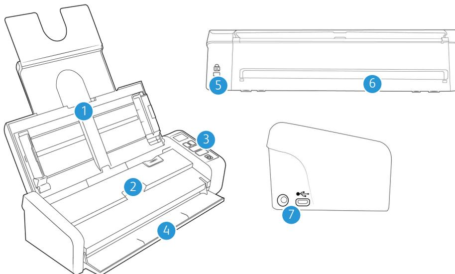
1. **Загрузочный лоток** — позволяет фиксировать положение документов в устройстве автоматической подачи для сканирования.
