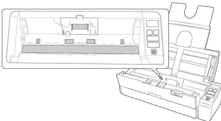
4. Протрите валики и стекло на нижней стороне дверцы АПД. Поворачивайте валики, чтобы очистить всю поверхность.
