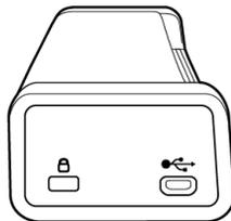
Utilizzare questo slot per collegare il cavo micro USB allo scanner. Non utilizzare altri tipi di cavo USB. Non tentare di installare una serratura di sicurezza in questa porta.
